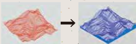
①実際の地図データから3次元の加工データを作る。 ②加工データからPCでシミュレーションする。
