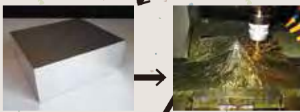
③1枚の四角いアルミ板から削りあげる。 ④機械で精密かつ、象徴的に削り出す。
